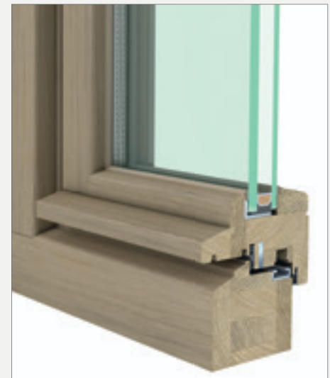
IV88+secure mit Sicherheitsklasse RC-3 Geprüfte Sicherheit für Ihr schönes Zuhause: Nur wenige Hersteller in Deutschland fertigen Holzfenster in der Widerstandsklasse RC-3.
